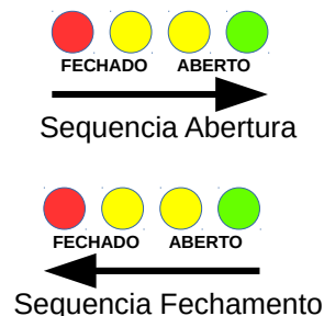
FIGURA 3: Sequencia de acionamento dos leds em operação.
